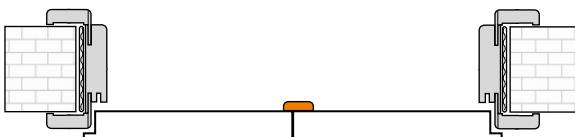
MODULOVÉ A PLOCHÉ DVERE S REGULOVANOU ALEBO BLOKOVOU ZÁRUBŇOU DOSADACIA LIŠTA PO OBOCH STRANÁCH DVERÍ
