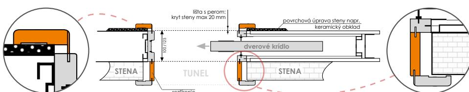
Šírka v rozsahu nad 20 mm sa nastavuje tak, že sa rozšíria jednotlivé komponenty rámu dverí – tunel (príplatok).
