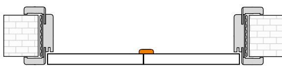
MODULOVÉ A PLOCHÉ DVERE S REGULOVANOU ALEBO BLOKOVOU ZÁRUBŇOU DOSADACIA LIŠTA ZO STRANY ZÁRUBNE
